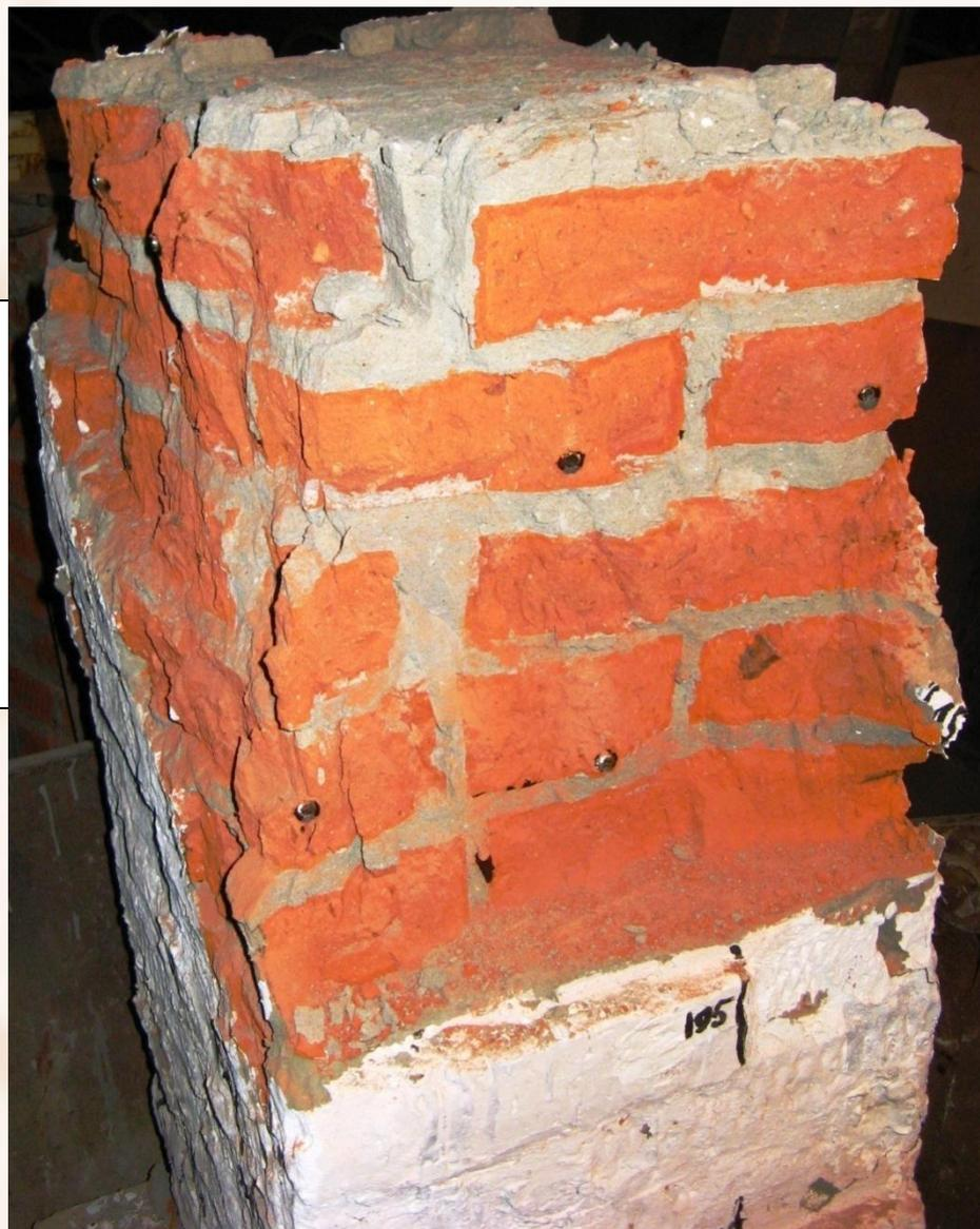
**Разрушение происходило не от образования трещин,
