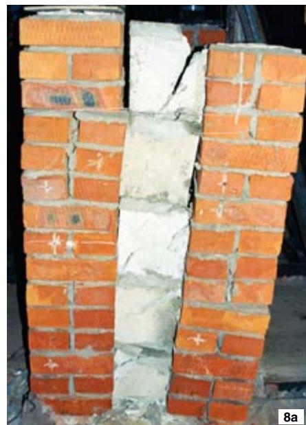
Рис. 8. Образцы стен с соединением слоев вертикальными диафрагмами из ячеистобетонных блоков после испытания на сдвиг между слоями
