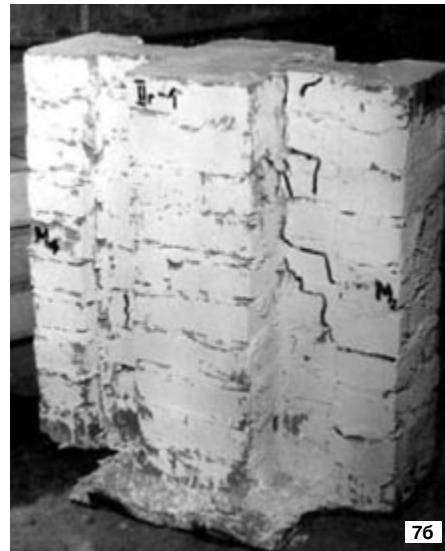
Рис. 7. Образцы стен с соединением слоев вертикальными кирпичными диафрагмами после испытания на сдвиг между слоями
