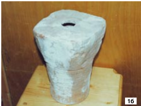
Рис. 2. Пустотелые камни для строительства Дворца Советов
