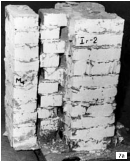
Рис. 7. Образцы стен с соединением слоев вертикальными кирпичными диафрагмами после испытания на сдвиг между слоями
