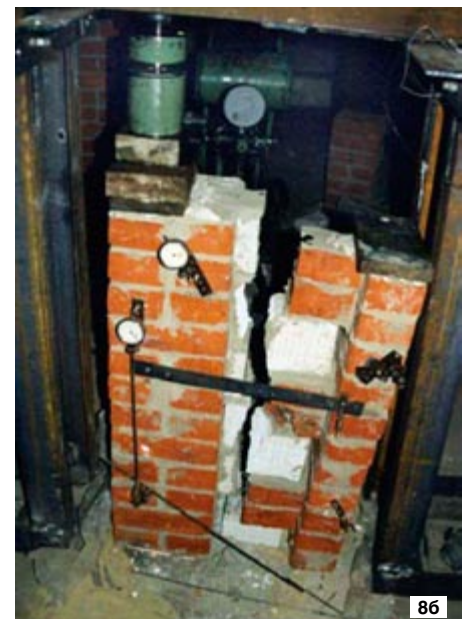
Рис. 8. Образцы стен с соединением слоев вертикальными диафрагмами из ячеистобетонных блоков после испытания на сдвиг между слоями
