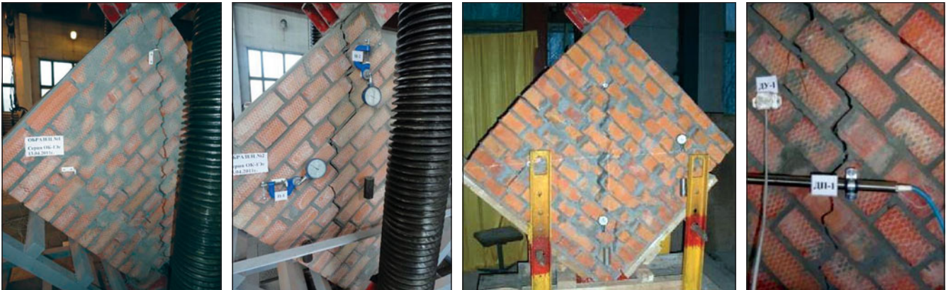
Рис. 9. Испытание на перекос кирпичной стенки [21]
