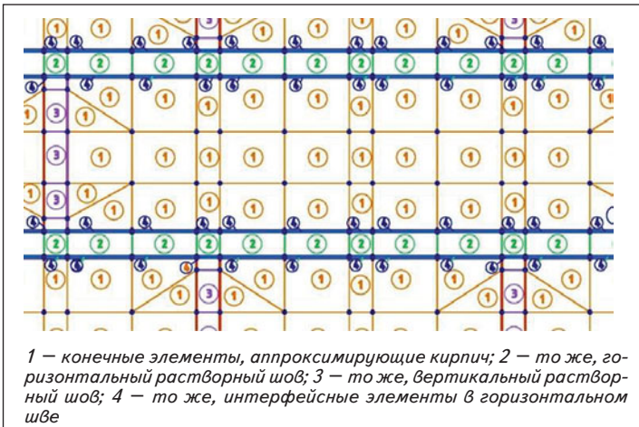
Рис. 3. Фрагмент конечно-элементной схемы микромоде-ли в работе О. В. Кабанцева [5]
