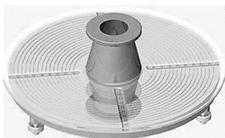
Рисунок 26 – Прибор АзНИИ для измерения растекаемости цементного, полимерцементного и цементно-известкового инъекционных растворов в соответствии с ГОСТ 26798.1
