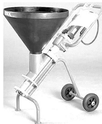
Рисунок 23– Шнековые насосы для прокачки микроцементов, цементных растворов со смесителем (а) и без смесителя (б)
