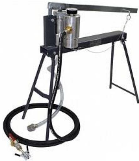
Рисунок 24 – Ручной поршневой насос для инъектирования микроцементов и других водных суспензий с крупностью заполнителя не более 0,3 мм (рабочее давление до 2 МПа)
